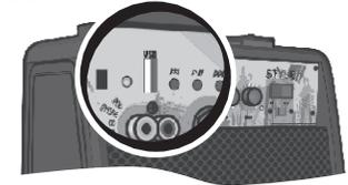
Sempre que usar um aparelho através da conexão USB, todos os ajustes de equalização, volume, play/pause, avançar e voltar, troca de pastas, passam a ser controlados somente através da caixa ou do controle remoto.
