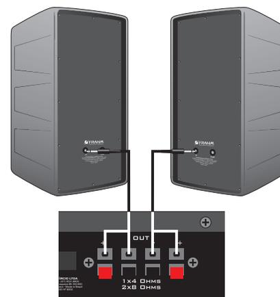
Esse exemplo de ligação ilustra a aplicação do USB Slim 2000 /Slim 2000 em escritório ou ambiente comercial, conectado a 2 (duas) caixas PS 300 da FRAHM, em 4 ohms.
