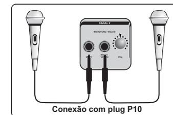
Conexão com plug P10
