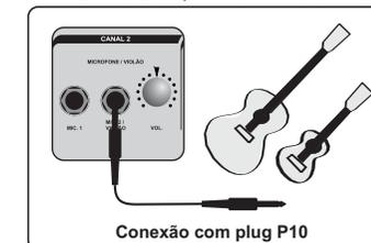
Conexão com plug P10
