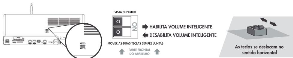
ATENÇÃO: Os ajustes devem ser feitos com o aparelho desligado, sob risco de queima!
