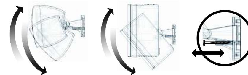
O parafuso de apoio está localizado na parte inferior do suporte, e auxilia na regulagem vertical da caixa, oferecendo maior nível de precisão para a regulagem e posicionamento da PS 200.
