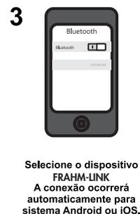
Em caso de dificuldade de conexão, desligue a caixa, aguarde 5 segundos e ligue a caixa novamente.
