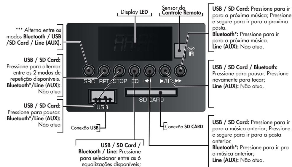
\* Bluetooth: O processo de comando da conexão via Bluetooth depende de pré-definição do aparelho. Verifique no manual do seu aparelho se ele permite esta função.
