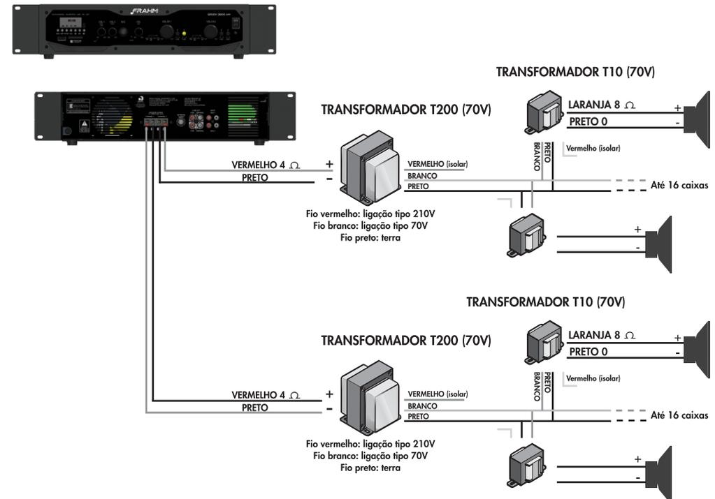
Obs.: A figura acima ilustra a ligação dos GR 3800 APP enviando o sinal para o Transformador T200 e os respectivos Transformadores T10, fazendo uso da linha de 70V.
