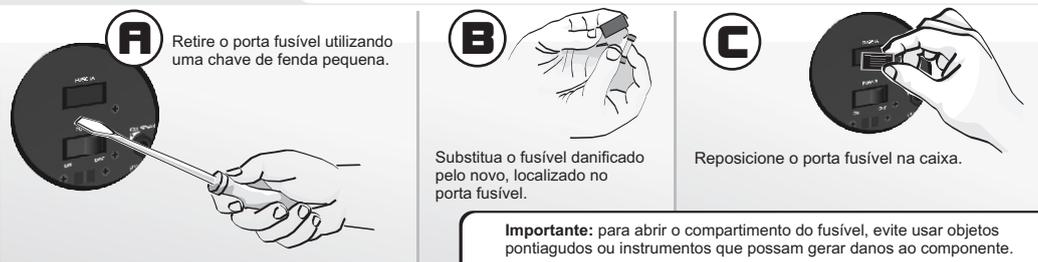
**ATENÇÃO :** As caixas seguem somente com um fusível reserva. Nunca substitua o fusível por outro de valor diferente aos dos especificados acima. Se o segundo fusível queimar, leve a caixa a um assistente técnico autorizado.
